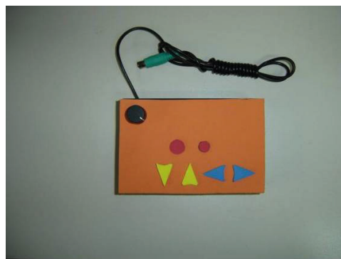
Figura 72 – Mouse de botão projetado no NAPNE Parte frontal com fundo alaranjado e seis botões para as funções do mouse em cores distintas Fonte: Cainelli (2011)
